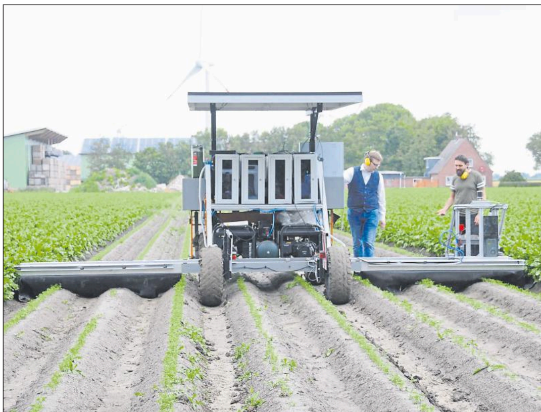
Der Jätroboter kann bis zu acht Reihen gleichzeitig von Unkraut befreien.
